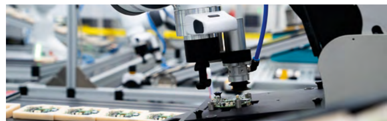
Rapid Tooling Roboteraufsatz: Vakuumgreifer mit Scanner
