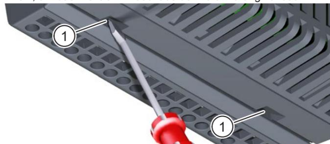
Abb. 7: Elektronikmodul deinstallieren
