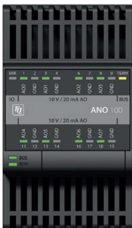
**Das Modul ANO100 bietet acht analoge Ausgänge auf engstem Raum. Die Kanäle sind als 0-10V oder 0(4)-20mA konfigurierbar.**
