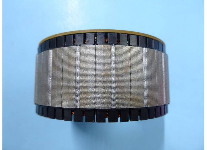
Hinweise zur Reinigung der Statoren vor dem Verbau finden Sie in der Integrationsanleitung zum jeweiligen Produkt. Wir empfehlen die Reinigung mit Isopropanol gem. Einbauanleitung wie unter Punkt 5.1.2. beschrieben.
