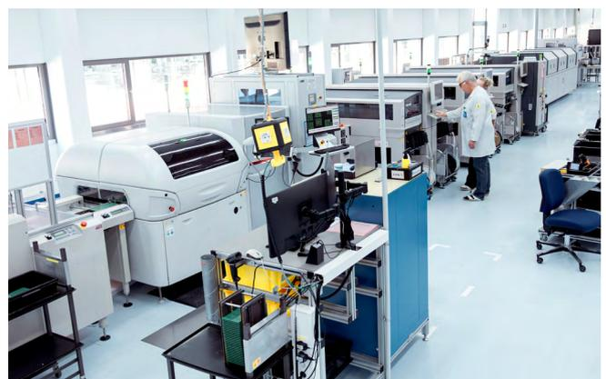
Das Kerngerüst der Elektronik-Bestückung: Die SMD-Fertigungslinie.
