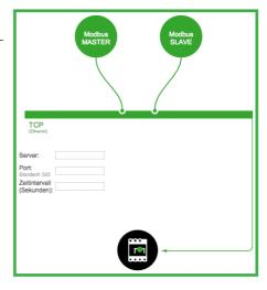
Der Energy Manager EM300 LR / EM300 LRW stellt seine Messwerte über Modbus-TCP und Modbus-RTU im Master- oder Slave-Modus zur Verfügung. Bei angeschlossen Sensoren aktiviert der Energy Manager die Modbus-RTU Kommunikation zu den Sensoren automatisch. Wenn Sie die Messwerte über Modbus-RTU an einen anderen Modbusteilnehmer übertragen wollen, müssen Sie die RTU-
