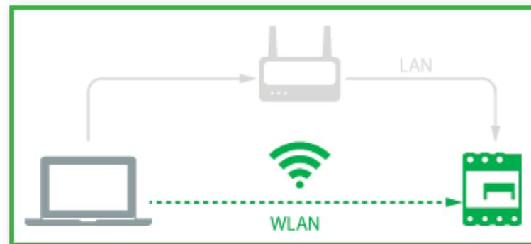
**Tipp** Sie können sich parallel auch direkt mit dem Smart Phone oder Laptop per WLAN mit dem B-control Energy Manager unter Angabe des Netzwerkschlüssels „bcon210pw“ verbinden. Wenn allerdings das WLAN des B-control Energy Managers nicht benötigt wird, sollte es abgeschaltet werden, um Energie zu sparen. Der Eigenverbrauch des Energy Managers ist geringer, wenn das WLAN deaktiviert ist.
