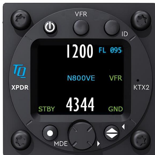
Commutateur GND installé, et avion au sol
